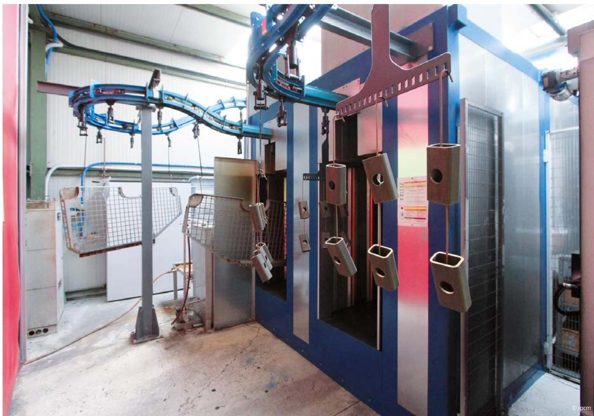
sono state attrezzate con centro polvere a nostro marchio, anch'esso realizzato su misura per essere inserito in uno spazio piccolo, ed erogatori di nostra concezione".
