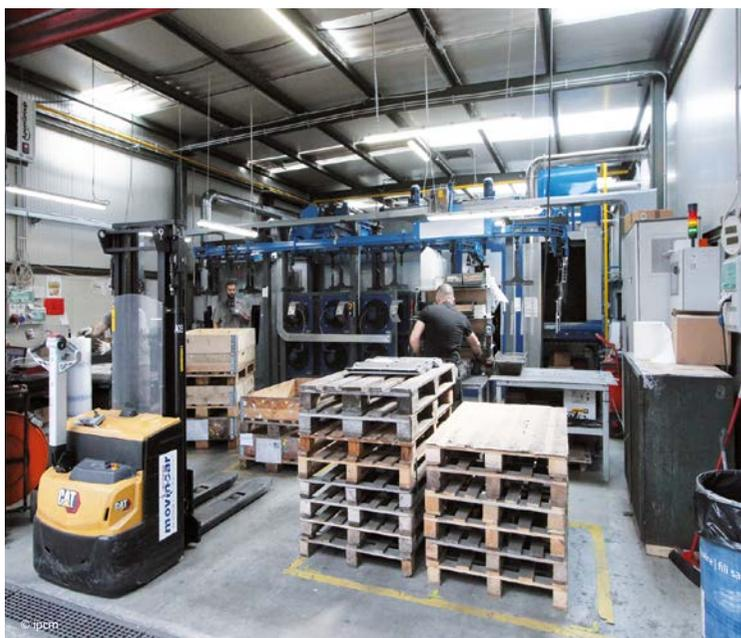
La linea di verniciatura a polvere, molto compatta, fornita da LEM Impianti.
