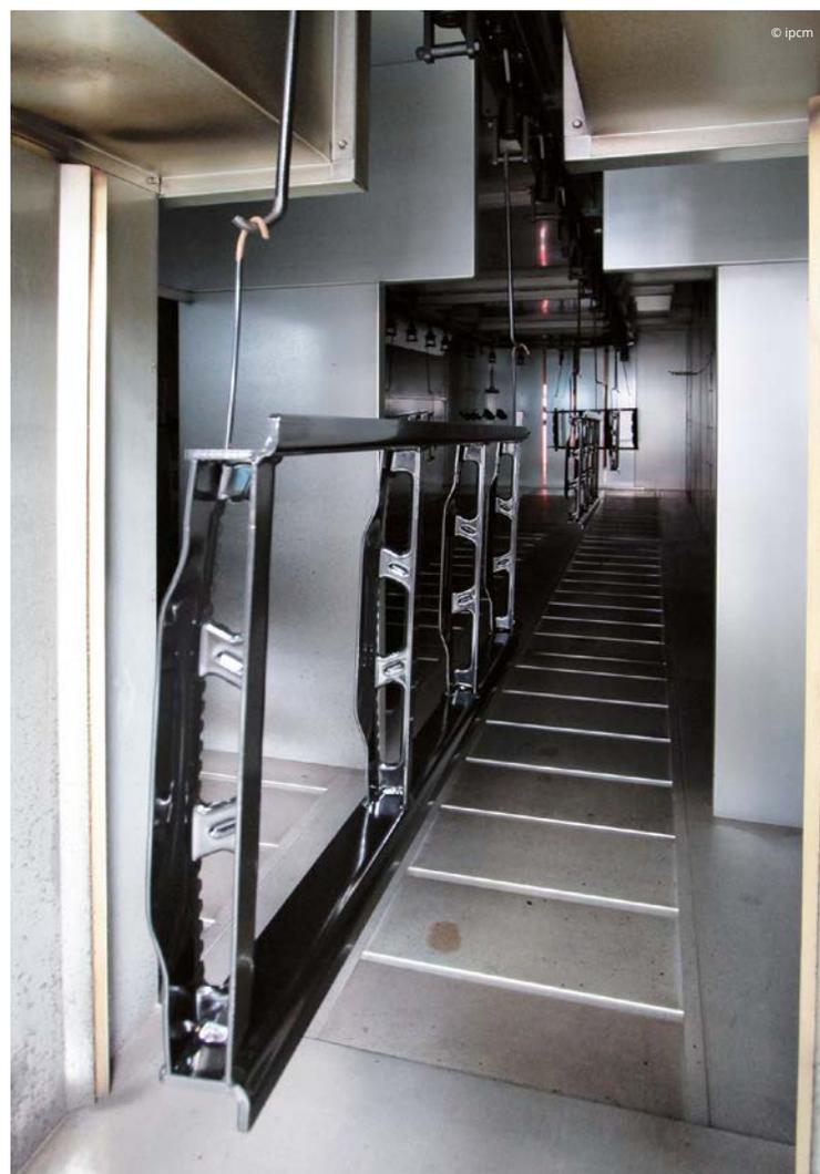
**Il forno ha una camera singola divisa in due zone: polimerizzazione nella prima sezione ed essiccazione nella seconda.**
